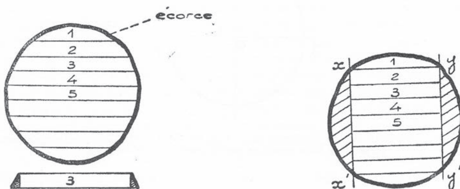
FIG. 11. — SCHÉMA DE LA SECTION TANGENTIELLE OU SUR DOSSE. Planche avivée et déchets de la grume.
