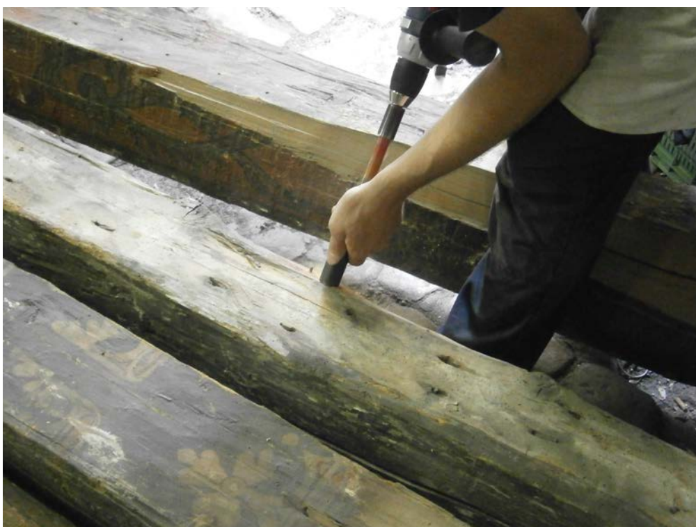
III.141. Metz, Musée de La Cour d'Or, analyse dendrochronologique du plafond peint du n°12-14 rue du Change - carottage de la solive n°IIa, 21 juillet 2011. Photographie: A.P.-N.P.
