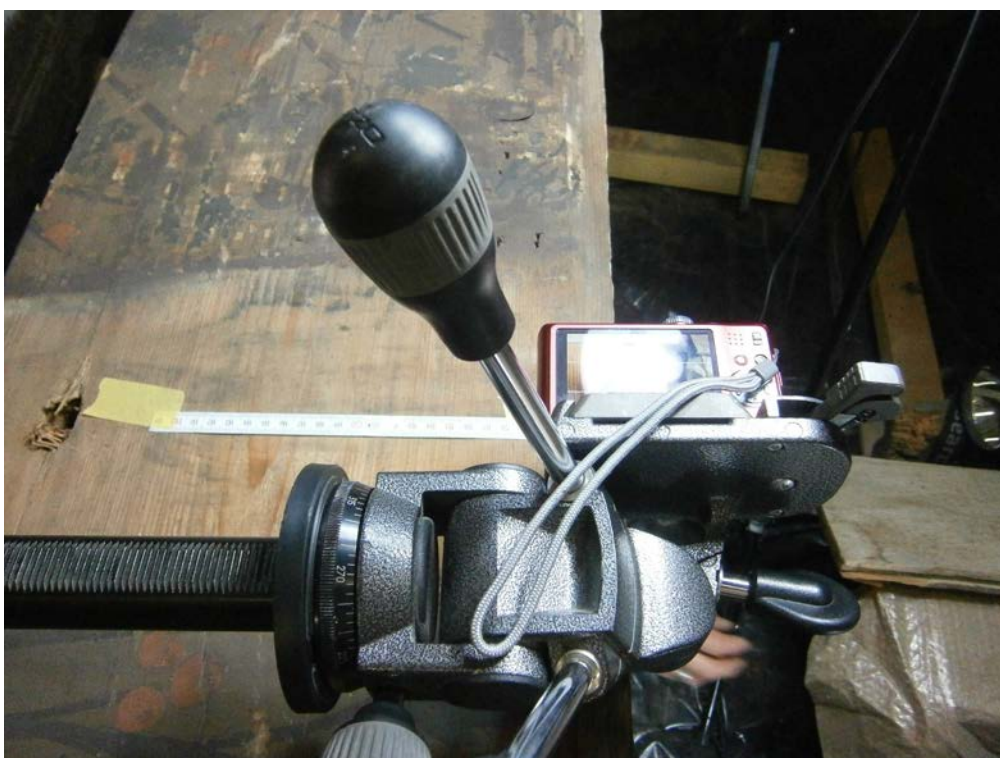
III.139. Metz, Musée de La Cour d'Or, analyse dendrochronologique du plafond peint du n°12-14 rue du Change - relevé macrophotographique des cernes de croissances de la planche n°5b, 19 juillet 2011. Photographie: A.P.-N.P.
