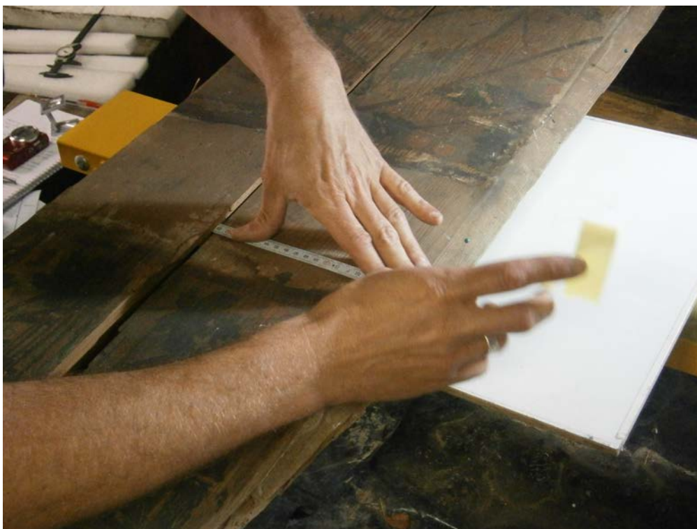
III.131. Metz, Musée de La Cour d'Or, analyse dendrochronologique du plafond peint du n°12-14 rue du Change - relevé des cernes de croissances de la planche n°11b, 18 juillet 2011. Photographie: A.P.-N.P.
