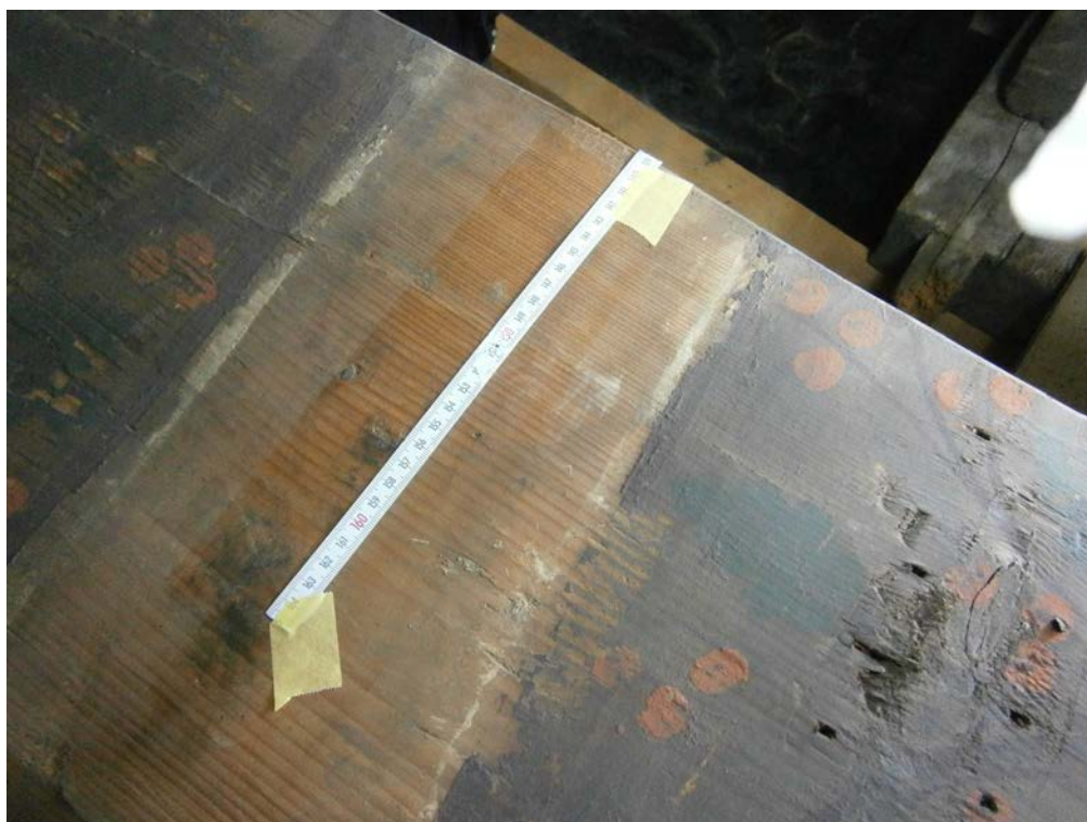
III.132. Metz, Musée de La Cour d'Or, analyse dendrochronologique du plafond peint du n°12-14 rue du Change - relevé des cernes de croissances de la planche n°8b, 18 juillet 2011. Photographie: A.P.-N.P.
