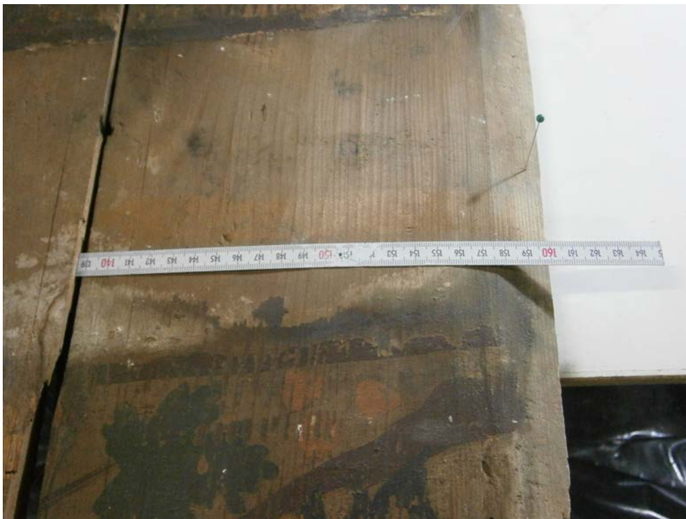
Ill.136. Metz, Musée de La Cour d'Or, analyse dendrochronologique du plafond peint du n°12-14 rue du Change - relevé des cernes de croissances de la planche n°11b, 18 juillet 2011. Photographie: A.P.-N.P.
