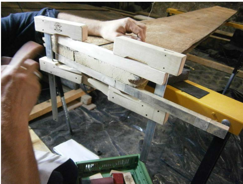
III.137. Metz, Musée de La Cour d'Or, analyse dendrochronologique du plafond peint du n°12-14 rue du Change - relevé des cernes de croissances de la planche n°4b, 19 juillet 2011. Photographie: A.P.-N.P.
