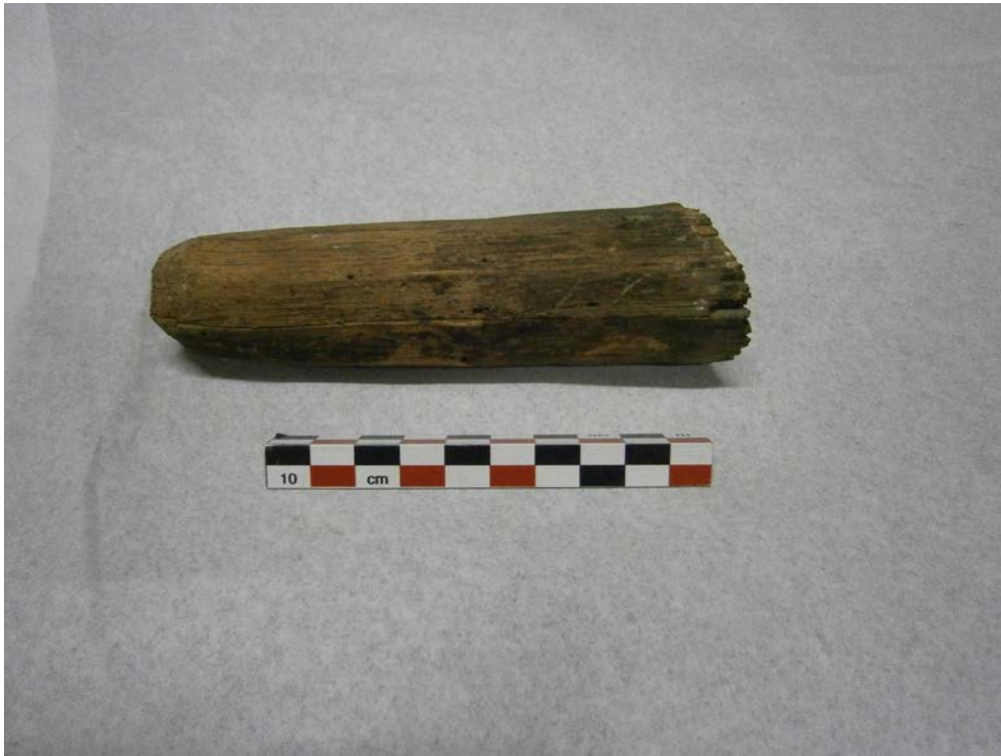
III.146. Metz, Musée de La Cour d'Or, étude tracéologique du plafond peint du n°12-14 rue du Change - goujons en chêne provenant de l'extrémité de la solive IIa-face B, 21 juillet 2011. Photographie: A.P.-N.P.
