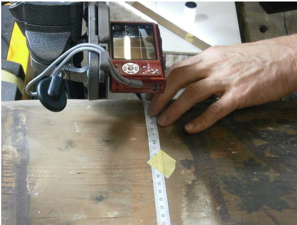
III.133. Metz, Musée de La Cour d'Or, analyse dendrochronologique du plafond peint du n°12-14 rue du Change - relevé macrophotographique des cernes de croissances de la planche n°11b, 18 juillet 2011. Photographie: A.P.-N.P.
